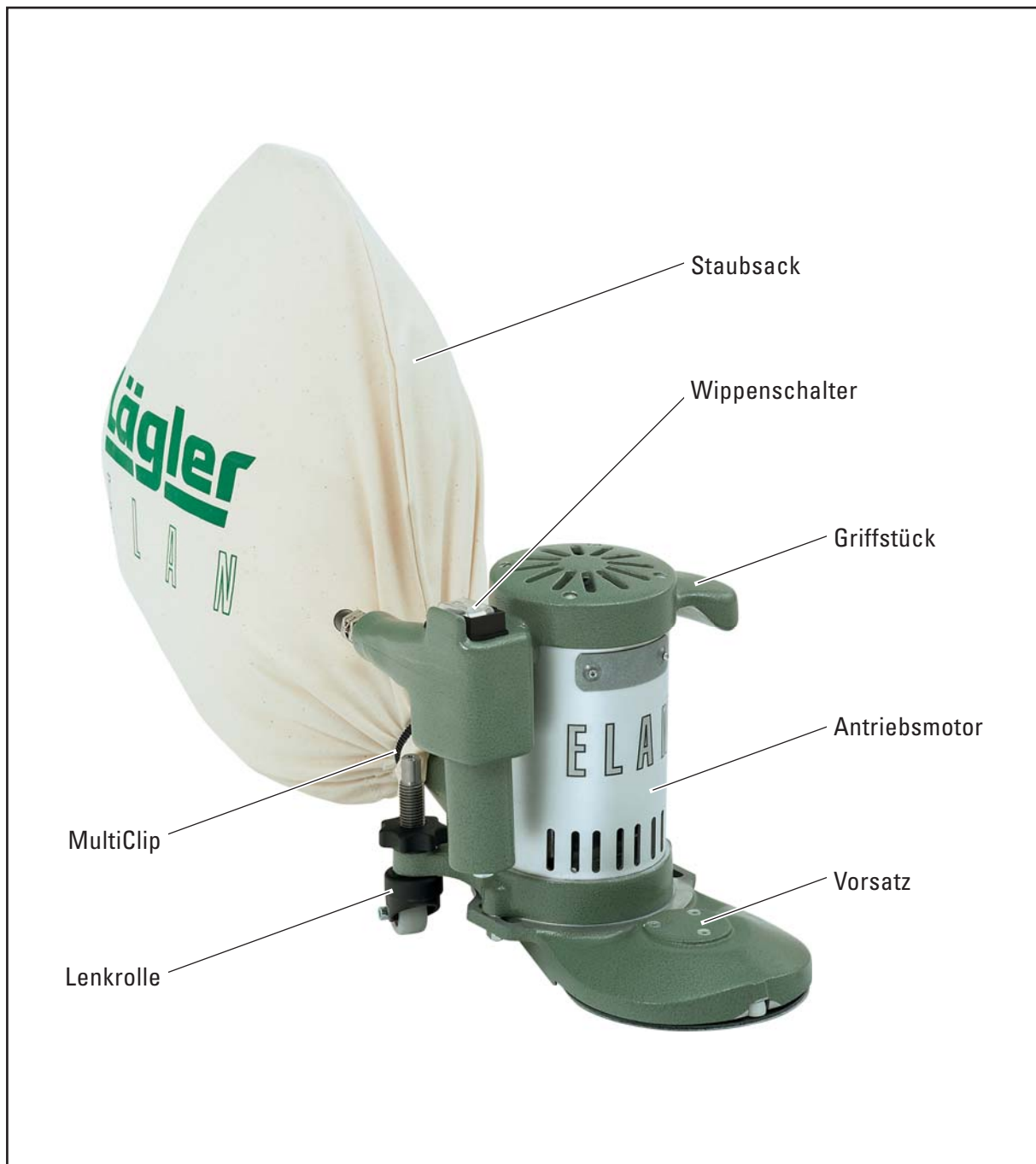
Abb. 1: Baugruppen der Rand-, Treppen- und Eckenschleifmaschine ELAN
